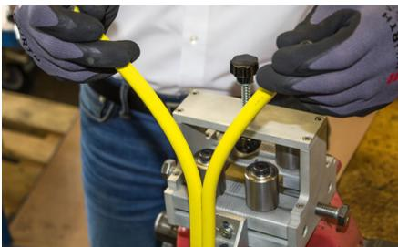
Überprüfen Sie unmittelbar nach der Trennung der Schläuche die Unversehrtheit der Außendecke. Wenn sie versehentlich aufgeschnitten wurde und der Druckträger freiliegt, ist es notwendig, diesen defekten Teil zu entsorgen.
