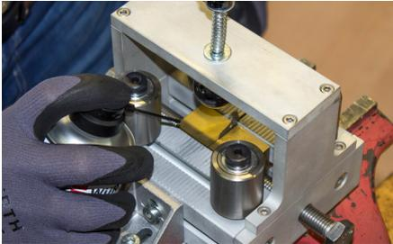
Positionieren Sie den Schlauchtrenner MZS-Universal in einem Schraubstock und spannen Sie ihn fest. Schieben Sie die Führungsrollen auseinander. Ölen Sie die Oberseite des Schneidmessers ein.
