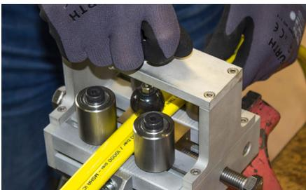
Halten Sie den Schlauch fest und drücken Sie die Führungskugel nach unten. Nun ziehen Sie den Schlauch langsam durch die Klinge.
