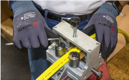
Positionieren Sie die Führungsrollen neben beiden Seiten des Schlauches und ziehen Sie sie fest. Der Schlauch muss parallel zu den Referenzlinien verlaufen.
